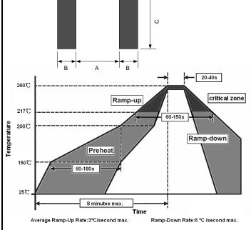
Solder Pad Layout В С Α **Part Number** (mm) (mm) (mm) LP-MSM200/30H 3.10 1.68 3.20
